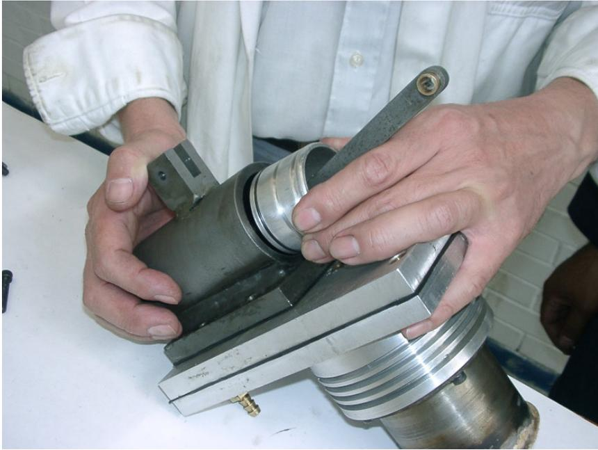
Montaje del Pistón de potencia.
