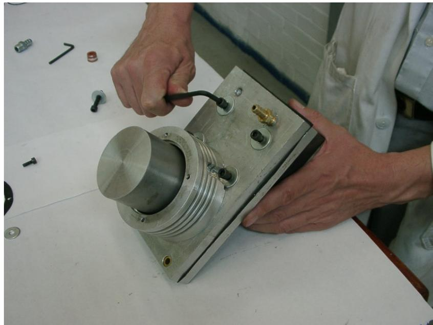
Armado del motor Robinson, mostrando aletas de enfriamiento, desplazador de aire y la unión de placas.
