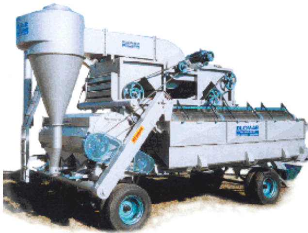
Fig. 3 Máquina clasificadora / limpiadora de chicharos móvil / separadora a discos alveolados por largo.
