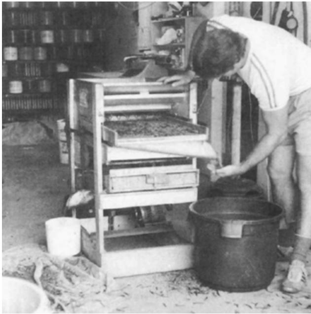
Fig 2. Proceso semi-mecanizado para la limpieza del chicharo
