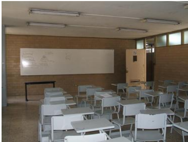
Foto No.9- Muestra las características Arquitectónicas y los elementos por los cuales se pierde el aislamiento acústico, de un aula escolar perteneciente a la Escuela Superior de Ingeniería y Arquitectura.
