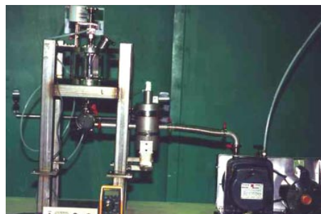
Figura 3.28. Vista lateral del sistema de degradado con XeF_2 en estado gaseoso cortesía de CONCAVE Research Center
