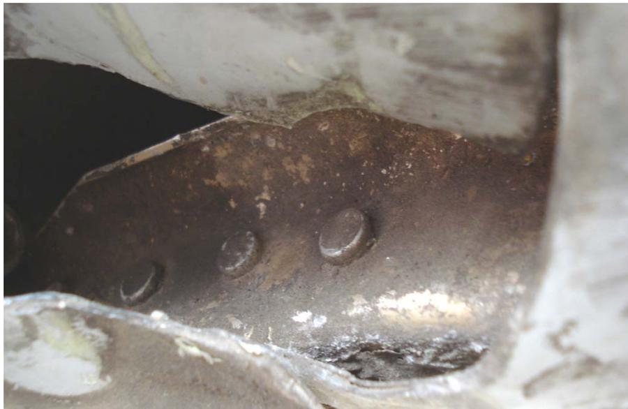
Figura C. Corrosión tipo exfoliación presente en el larguero.
