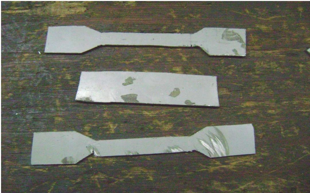
Figura 26. Probetas a las que se les aplico ensayos de tensión y flexión.
