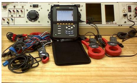
**Figura A. 75.** *Power Pad<sup>TM</sup> Modelo 3945 Características del Producto.*
