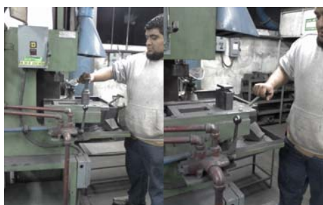
Figura. 43. Avance y centrado del molde de pastillado.
