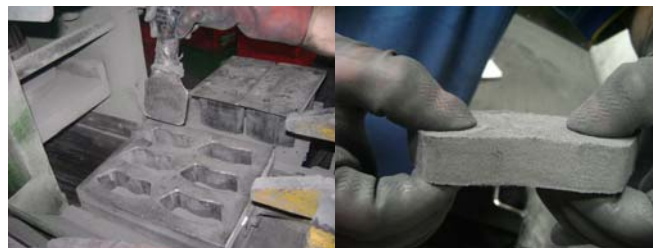
Figura. 3 Cargado de mezcla e inspección de pastilla de forma manual.
