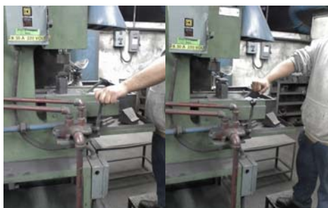
Figura. 44. Aplicación de presión y retroceso del molde.
