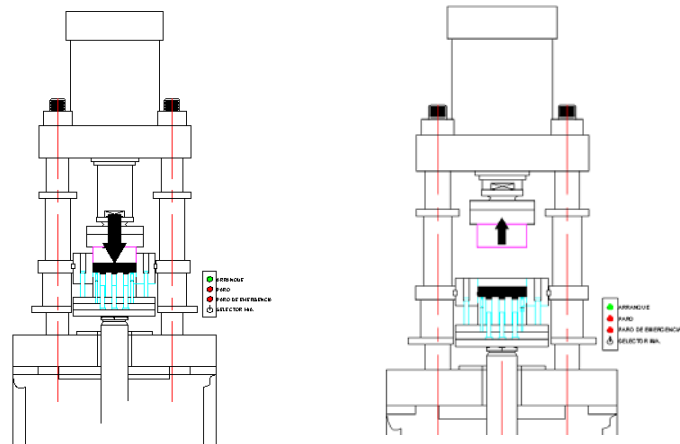
Figura. 76. Compactación final de pastilla.
