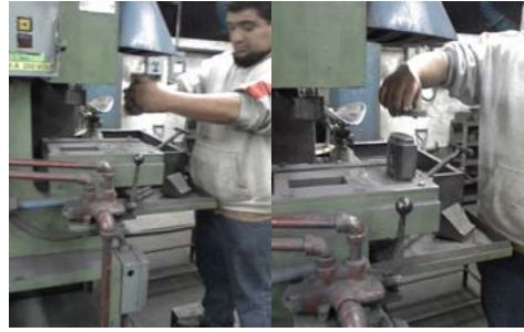
Figura. 45. Ilustración de la extracción de la pastilla de forma manual.
