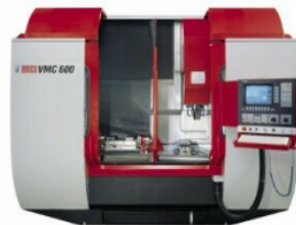
Figura. 9. Centro de maquinado CNC.
