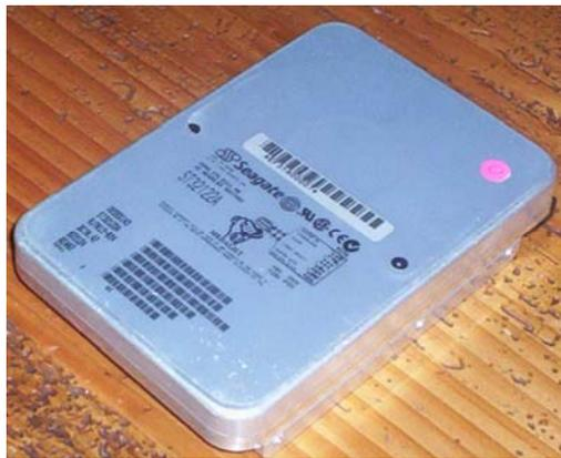
Figura 1.5. Fotografía de un disco duro <sup>5</sup>
