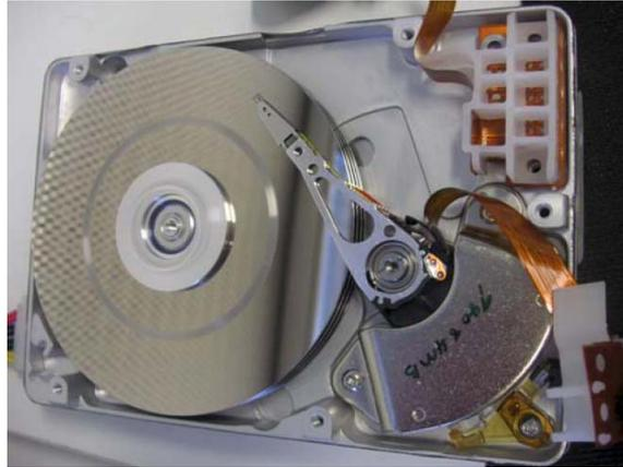
Figura 1.6. Fotografía del interior de un disco duro <sup>6</sup>
