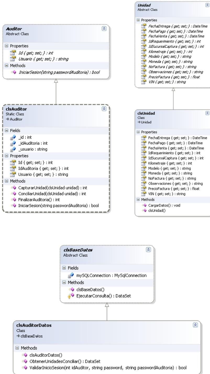
Fig. 4.55. Diagrama de clases del sistema móvil
