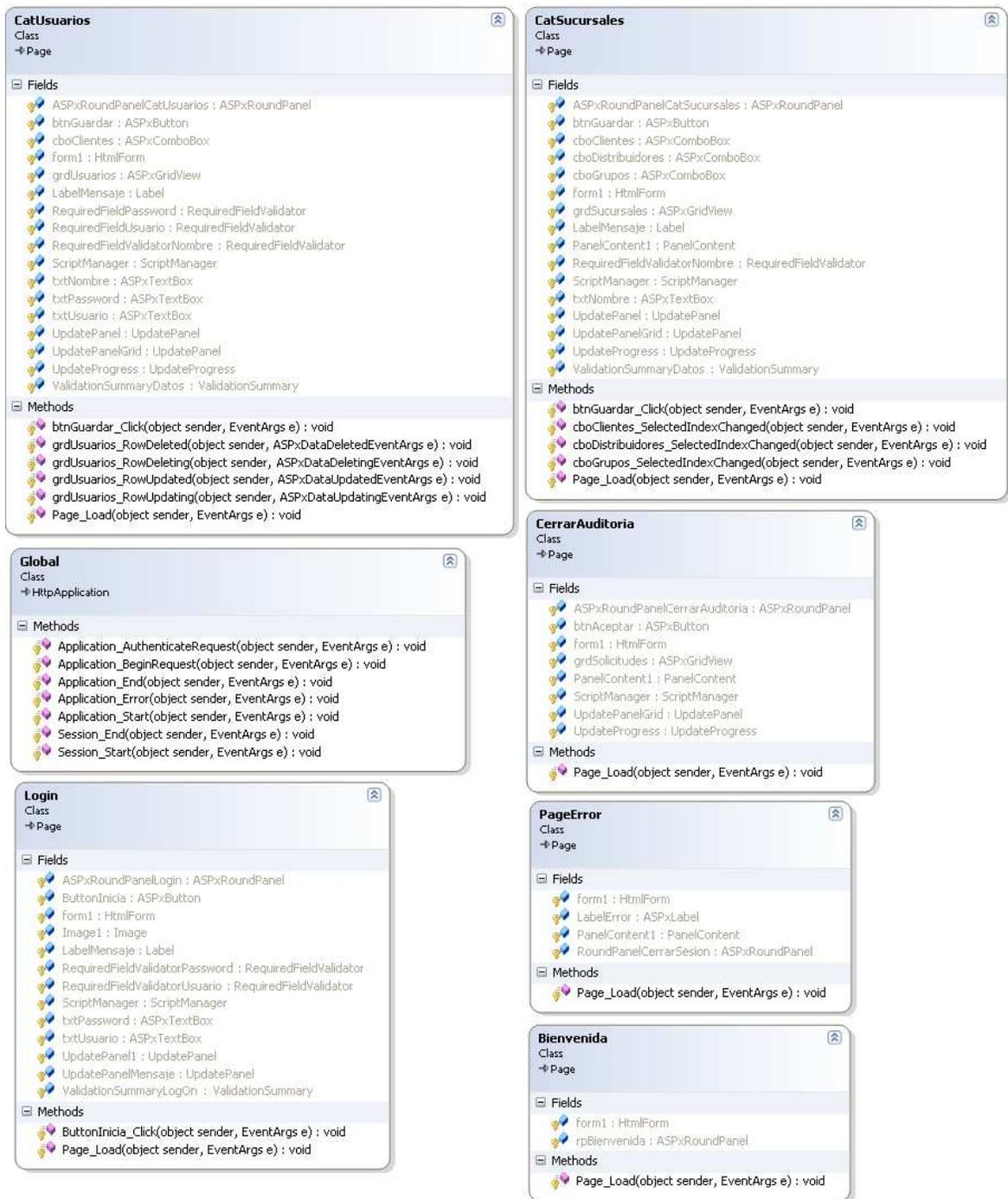
Fig. 4.31. Diagrama de Clases del sistema
