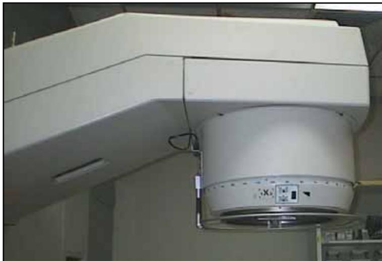
**Figura 3.10** Cabezal del acelerador lineal Phillips SL-15.
