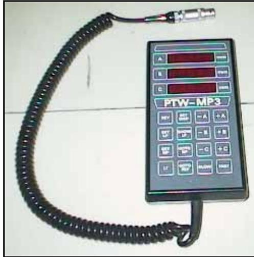
**Figura 4.5** Teclado del control donde se muestran los tres ejes de coordenadas simultáneamente
