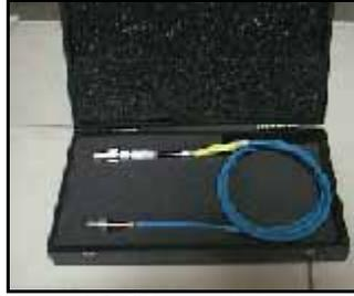
**Figura 4.2** Cámara de Ionización
