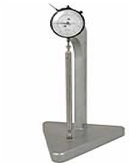
Figura 19. Comparador de longitudes con carátula digital Marca HUMBOLD MFG CO H mod. 3250.
