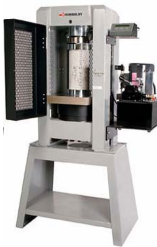
Figura 18. Prensa hidráulica para medir la resistencia a la compresión, Marca Soilest Modelo CI-7510.
