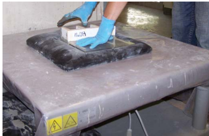
Figura 22. Vibrado de mezclas de cemento.
