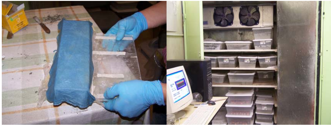
Figura 23. Muestras selladas y listas para ingresar a la cámara de curado
