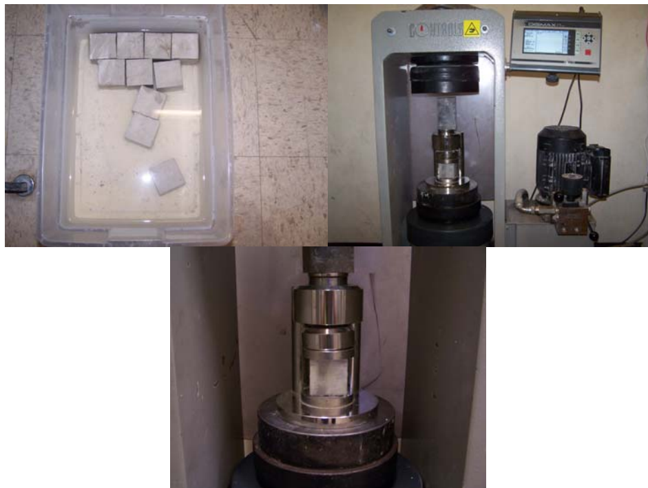
Figura 24. Procedimiento de ensayo de Resistencia a la compresión
