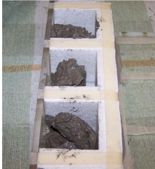
Figura 21. Moldes llenados a la mitad antes de ser vibrados.
