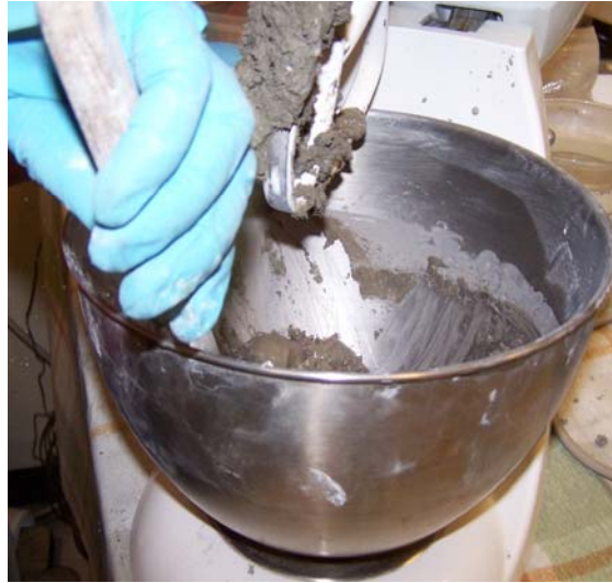
Figura 19. Incorporación de mezcla adherida al recipiente.
