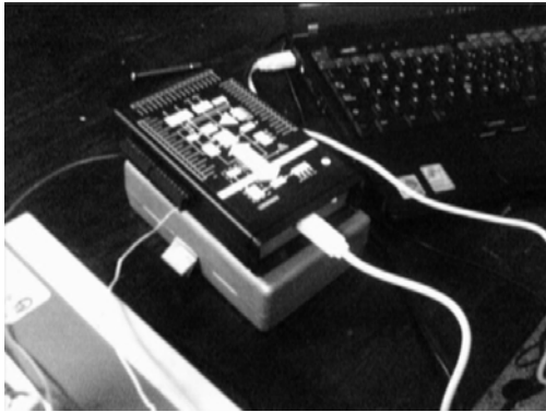
Figura 6.3 Conexión de tarjeta de adquisición de datos a PC y a modelo.
