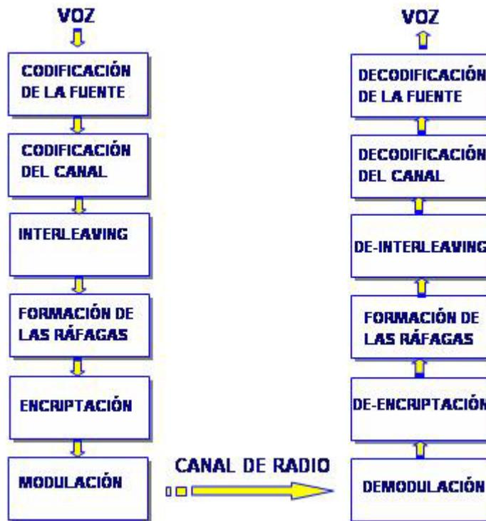
Figura 2.9 Funciones de procesado de voz en GSM
