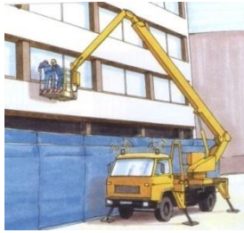
Ilustración 12. Plataforma elevadora instalada sobre el bastidor de un camión
