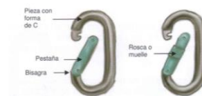
Ilustración 17. Mosquetones, sin seguro y con seguro
