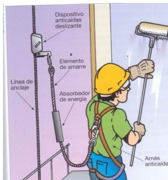
Ilustración 14. Arnés y sistema anticaídas
