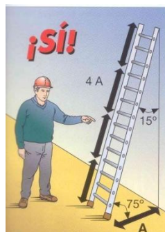
Ilustración 1. Colocación correcta de una escalera
