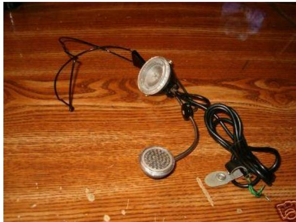
*Figura No. 2.7.1 B. La versión revolucionaria de 1970 de audífonos ya aplicado a operadores telefónicos creada por la empresa Geovictor: El Modelo “Starset”. (Bell Systems, 2007)*
