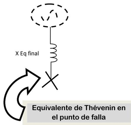
Fig. 2.9 (Continuación) Procedimiento de reducción del sistema a reactancia equivalente.
