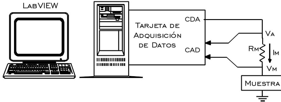
Figura 2.6.- Procedimiento experimental propuesto para determinar la característica V-I.
