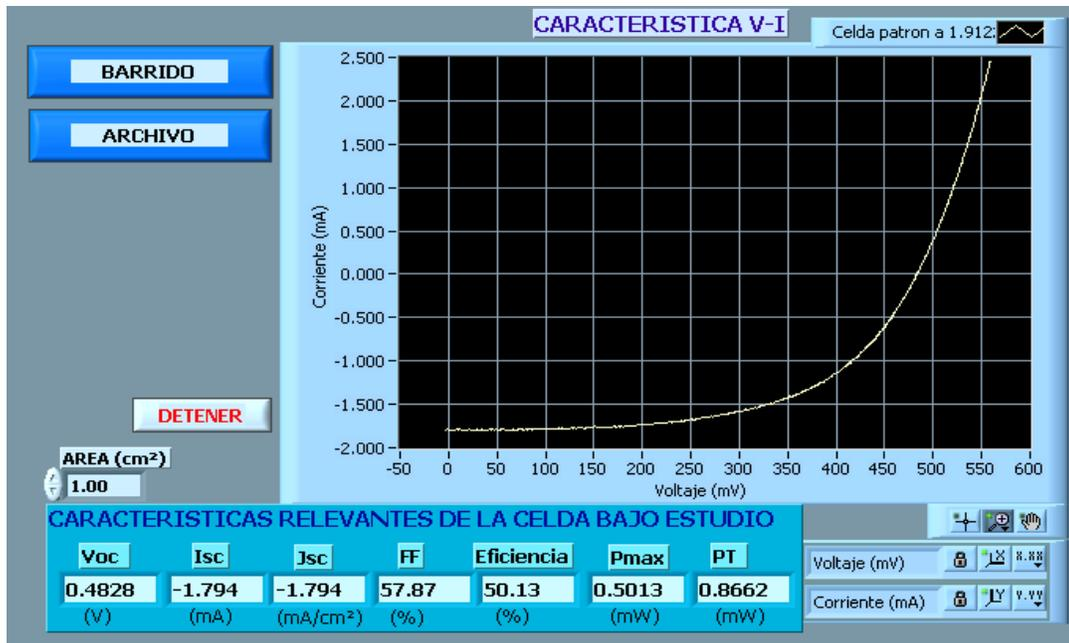
Figura 6.2.- Celda patrón con una potencia incidente de 100 mW/cm<sup>2</sup>.
