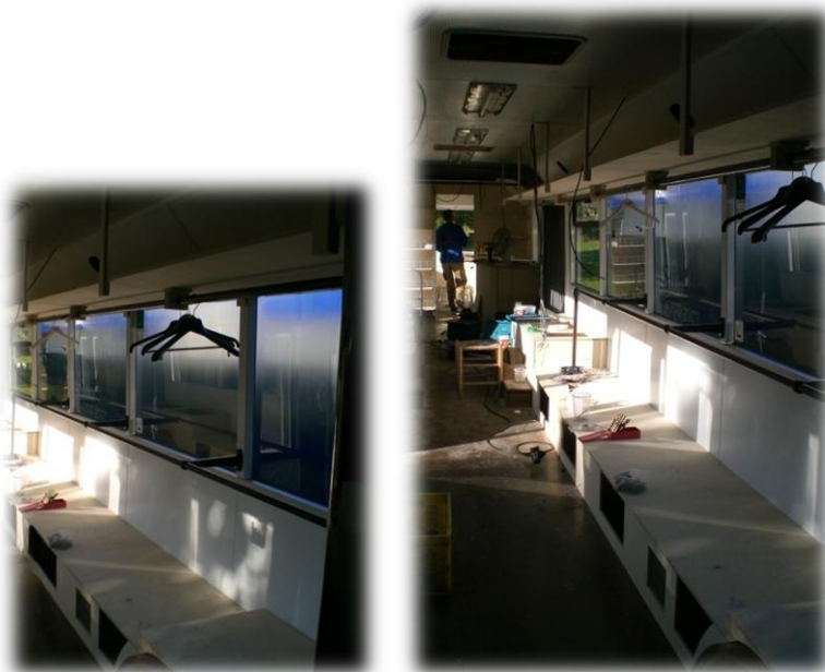
Foto 1 - 3 Vista del rediseño aplicado al segundo autobús, se eliminaron las estanterías y se sustituyeron por la utilización de barras para el colgado de las prendas, a la parte inferior de la superficie de depósito de mercancía se le realizaron orificios para el depósito de balones.
