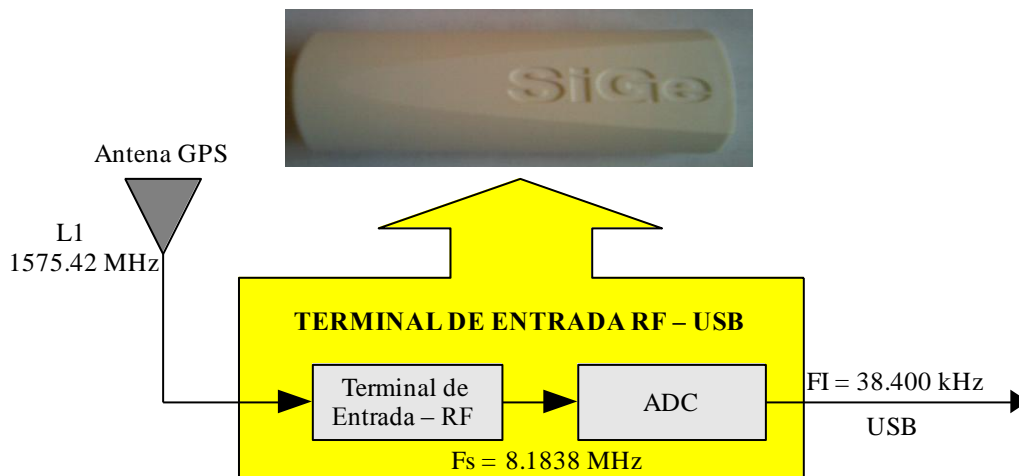
FIGURA 5.2. Antena y terminal de entrada dentro de la arquitectura del receptor GPS propuesto.
