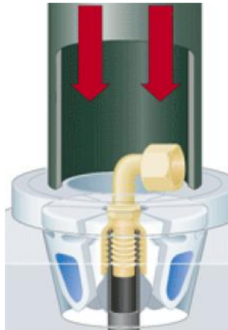
Fig. 1.6.2 Proceso de prensado para la fabricación de latiguillos de freno.
