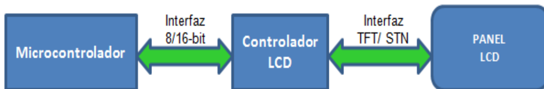
Figura 12. Controlador externo para configuración del LCD.
