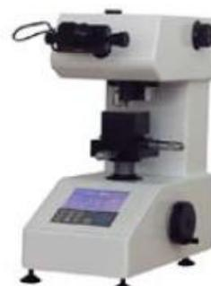
Figura 3.8. Equipo para el análisis de microdureza.
