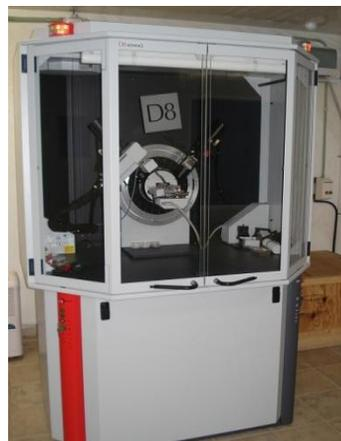
Figura 3.3 Difractómetro Bruker D8 Advanced.
