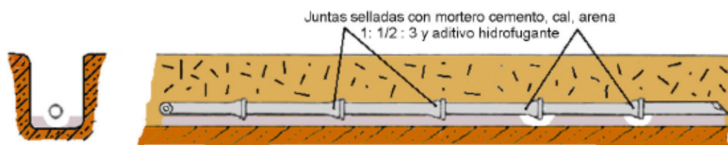
COLOCACION DE TUBOS DE CONCRETO EN CEPA
