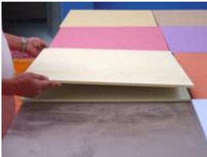
Secado duro. Se considera secado duro, cuando cualquier marca ejecutada con máxima presión del dedo pulgar es completamente removida por un ligero pulido con un trapo suave.
