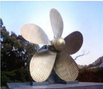
Su función es transmitir a través de las palas su propia energía cinética (que adquiere al girar) a un fluido, creando una fuerza de tracción, o viceversa, "tomar" la energía cinética de un fluido para transmitirla mediante su eje de giro a otro dispositivo. El inventor de la hélice para los barcos fue el checo Josef Ressel.
