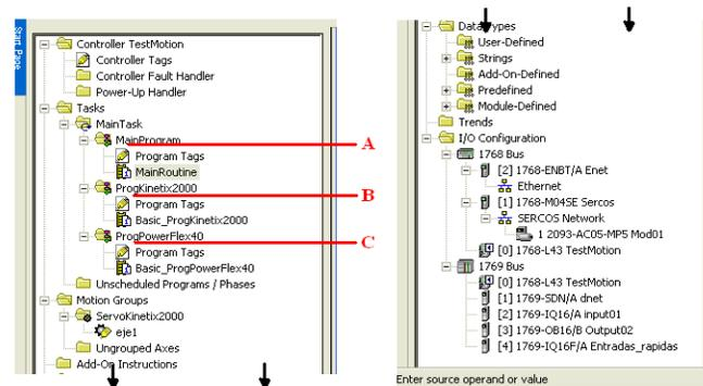
Figura 6.4 Controller Organizer del proyecto TestMotion
