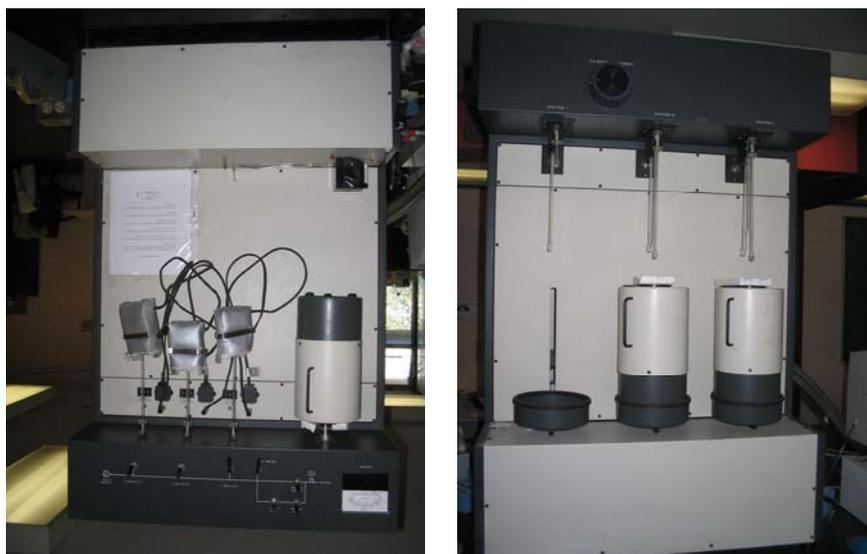
Figura 2.5 Equipo Quantachrome Autosorb-3B para determinación de propiedades texturales.
