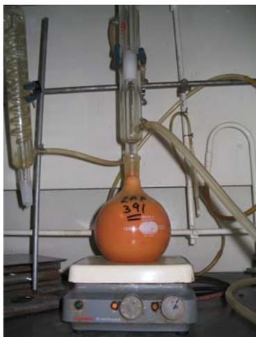
Figura 2.1. Sistema de reacción para la síntesis de HT.
