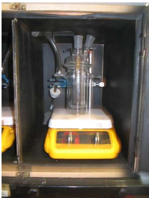
Figura 2.6 Reactor empleado en las pruebas de fotodegradación.
