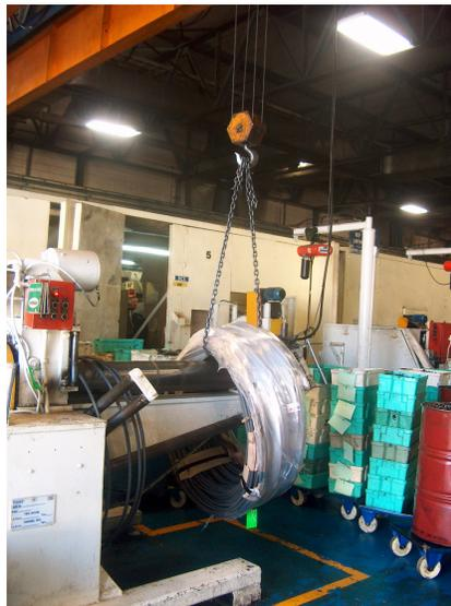
Figura 37. Fotografía de una máquina NEP dentro de las instalaciones de la empresa en estudio. Nótese la cabina sonoamortiguada en color beige y la ausencia de ductos de aspiración.
