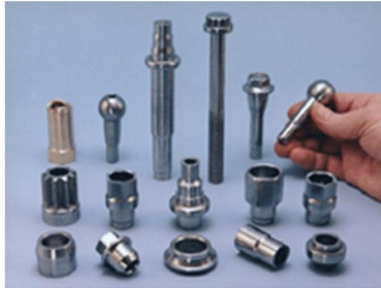
Figura 35. Fotografía de la variedad de metales y formas que se les puede dar con el formado en frío.
