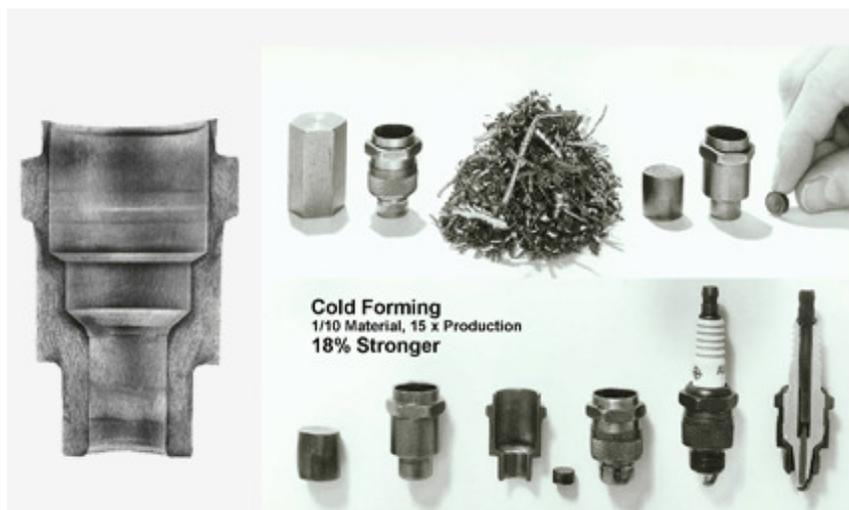
Figura 34. Esquema del proceso de formado en frío (*Cold Forming*).
