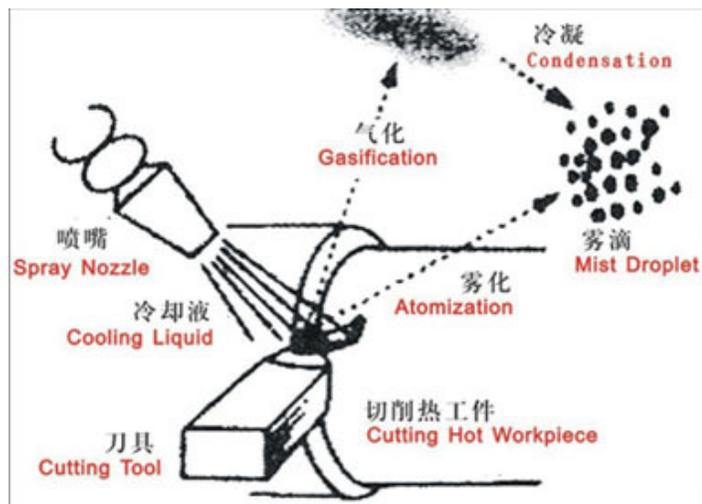
Figura 38. Esquema del sistema herramienta de corte-lubricante-pieza que muestra la manera en que se generan las neblinas de aceite durante el proceso de maquinado.
