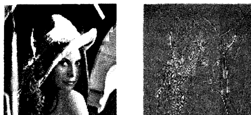
Figura 3.2.17. Imagen original y filtrada de paso alto.
