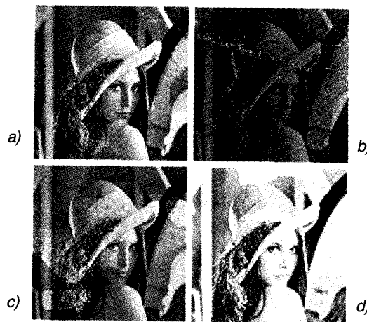
Figura 3.2.26. Filtrado de raíz. a) Imagen original; b) \alpha = 0,95 ; c) \alpha = 0,99 ; d) \alpha = 1,05 .
