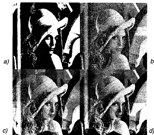
Figura 3.3.2. Ejemplo de codificación con dithering. a) Codificación a 1 bit sin dithering; b) codificación a 1 bit con dithering; c) codificación a 3 bits sin dithering; d) codificación a 3 bits con dithering.
