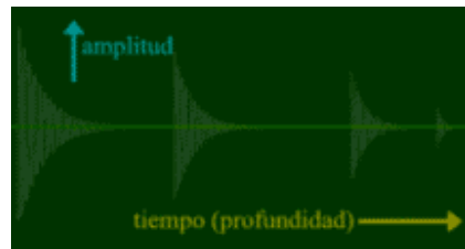
Figura 4.3.4.1 Grafica obtenida por un transductor ultrasónico tipo A
