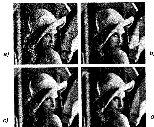
Figura 3.2.15. a) Imagen corrompida con ruido gaussiano; b) filtrado espacial 2 \times 2 ; c) filtrado espacial 3 \times 3 ; d) filtrado espacial 4 \times 4 .
