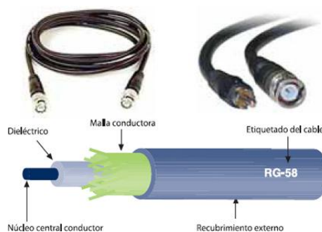
Figura 1 Tipos de cables para redes.
