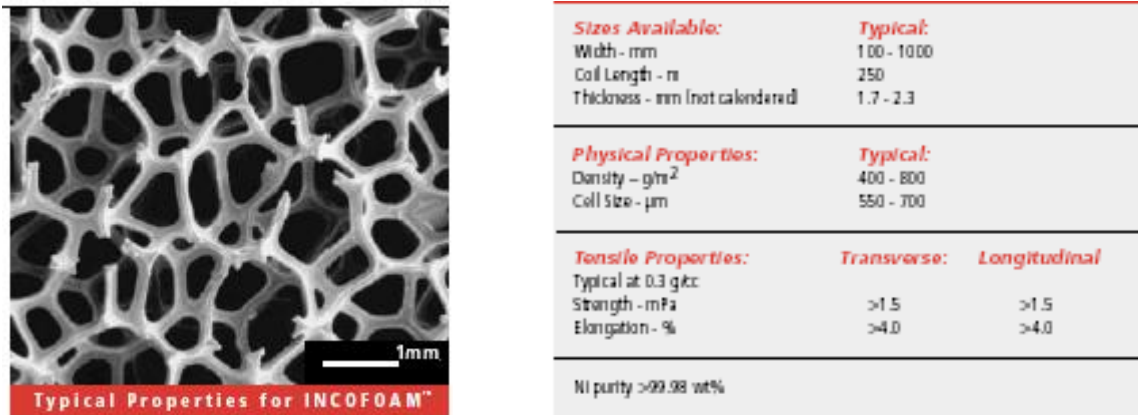
Figura 7. Izquierda, estructura en las espumas INCOFOAM; derecha, propiedades físicas y mecánicas.
