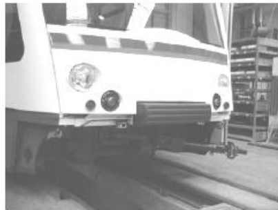
Figura 4, la caja de choques es un compuesto de espuma de aluminio y un polímero, recubierta de caucho
