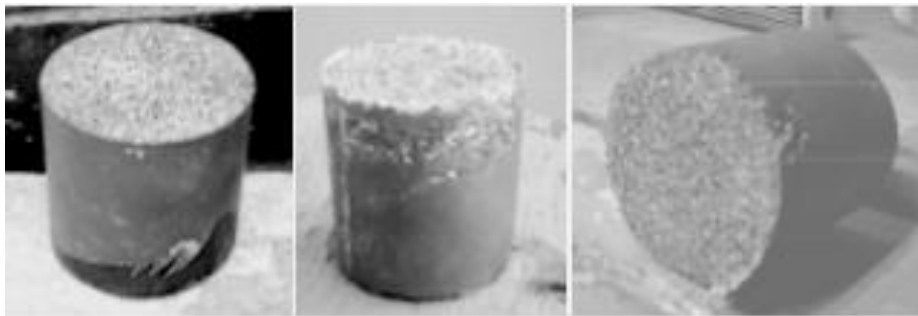
Figura 38a 450°C de calentamiento de la matriz y 5min de homogenizado permiten que el metal tenga la fluidez necesaria para llegar al fondo de la matriz en una forma estable
