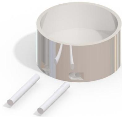
**Figura 4-7. Recipiente para probetas, con dos resistencias.**
