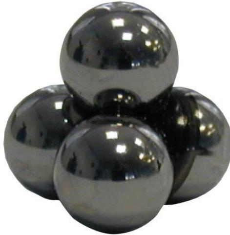
**Figura 3-5. Configuración tetraédrica de las cuatro bolas**
