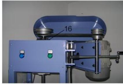
Figura D-3. Lubricación de baleros de carga y chumaceras.
