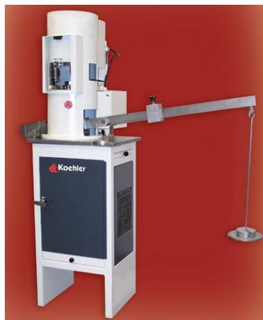
Figura 3-11. Máquina tribológica de cuatro bolas producida por Koehler Instrument Company
