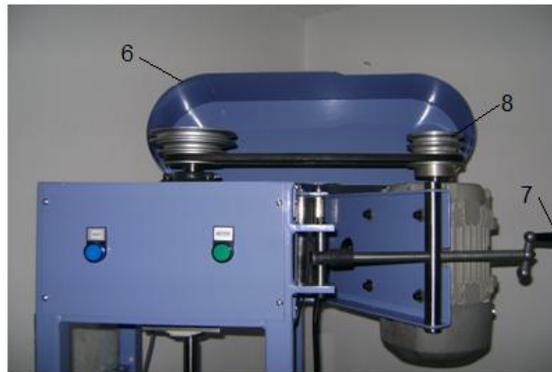
**Figura C-2. Ajuste de velocidad de rotación**
