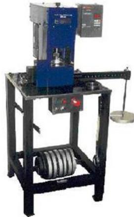
Figura 3-10. Máquina tribológica de cuatro bolas producida por IDP Aparatos.
