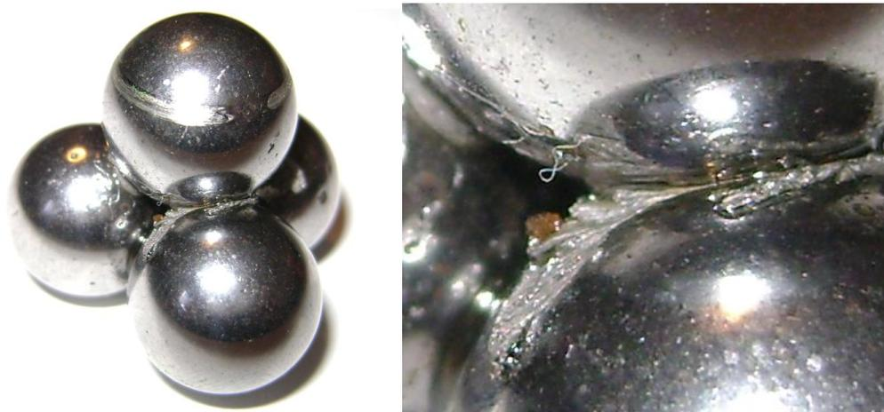
**Figura 5-23. Soldadura del tetraedro en una prueba no normalizada, velocidad 1770 RPM, carga 2205 N y temperatura 25°C y acercamiento del punto de soldadura**
