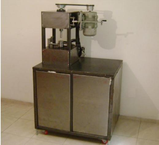
**Figura 16** Avance de máquina tribológica de cuatro bolas.
