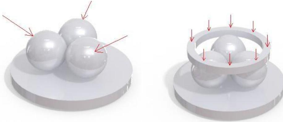
**Figura 4-4. Fuerzas necesarias para la sujeción de las esferas**
