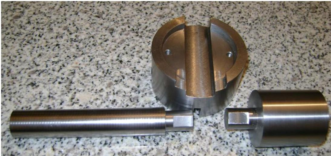
Figura 5-9. Brazo de palanca, platina y contrapeso maquinados.
