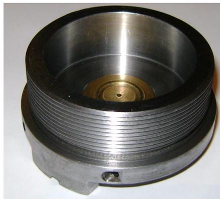
**Figura 5-5. Recipiente de probetas.**
