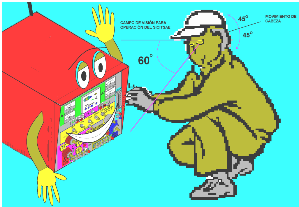
Figura 4.2.20. Dibujo que muestra los límites de movimiento y campo visual en las tareas de operatividad del usuario, fuente propia.
