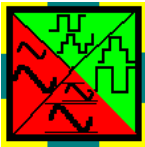
Figura 4.2.2.9. Dibujo que representa el Subsistema inversor de voltaje, convierte señal tipo C.C. a C.A. cuadrada o PWM , fuente propia.
