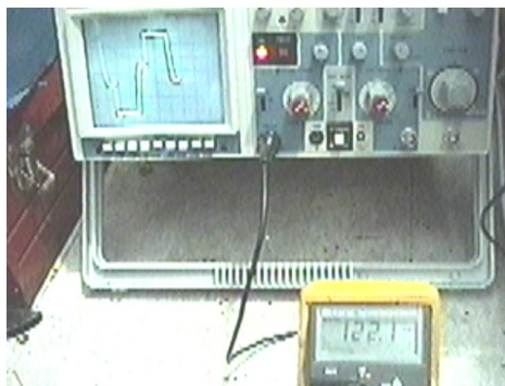
Figura 4.5.1.5. Fotografía que muestra la respuesta real de la planta de luz a media carga (focos y resistores), fuente propia.
