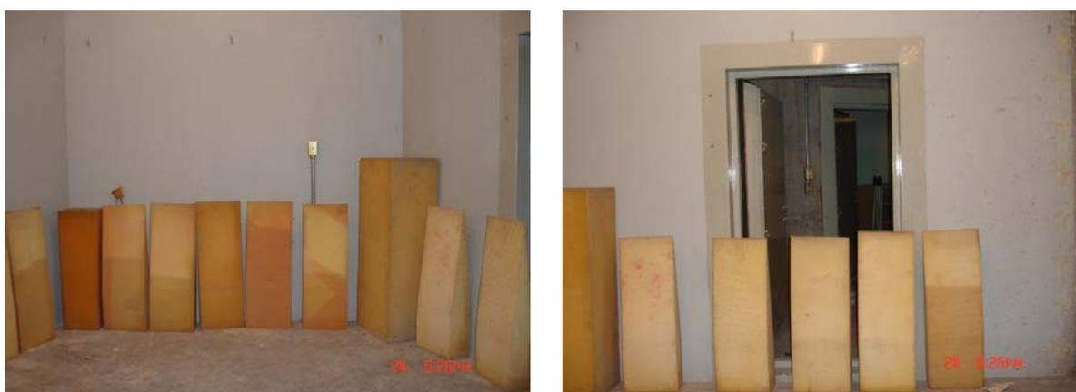
**Figura 9. Ubicación del material absorbente dentro del recinto receptor**
