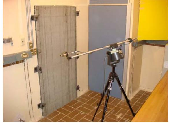
(c) Montaje de la partición de prueba
