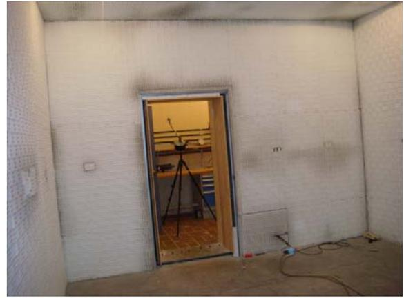
(d) Cámara semi-anechoica usada como recinto receptor
