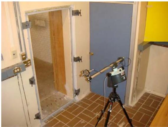
(b) Apertura de prueba y posición del boom giratorio
