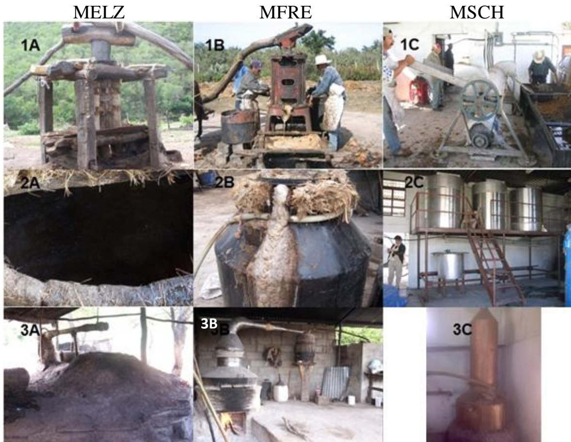
Figura 7 Proceso de elaboración de mezcal principales diferencias en las tres mezcaleras de estudio: 1A) trapiche artesanal, 2A) barril de fermentación, 3A) Alambique de destilación, 1B) tornillo de molienda, 2B) tanque de fermentación, 3B) alambique de destilación, 1C) molino mecánico, 2C) tanques de fermentación, 3C) alambique de destilación
