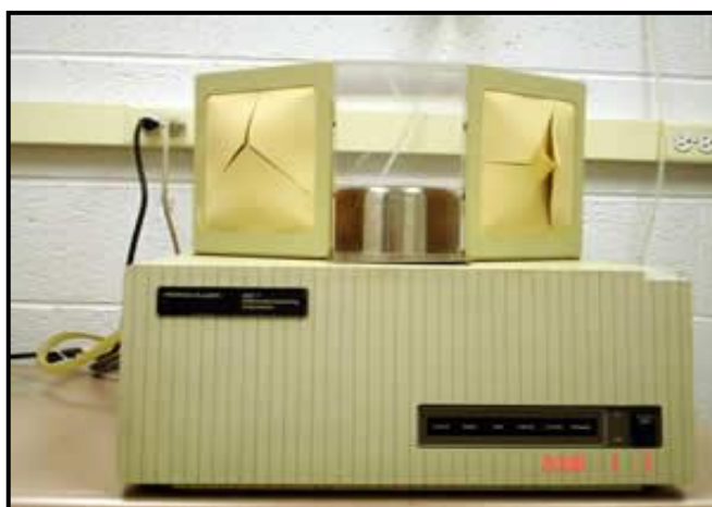
Figura 2.7.g. Calorímetro DSC 7 de Perkin Elmer.
