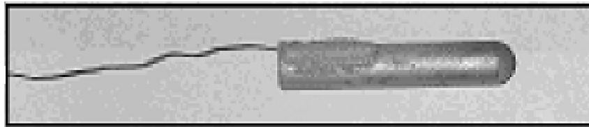
**Figura 11.** Sensor recubierto con Pt mediante la técnica de CVD
