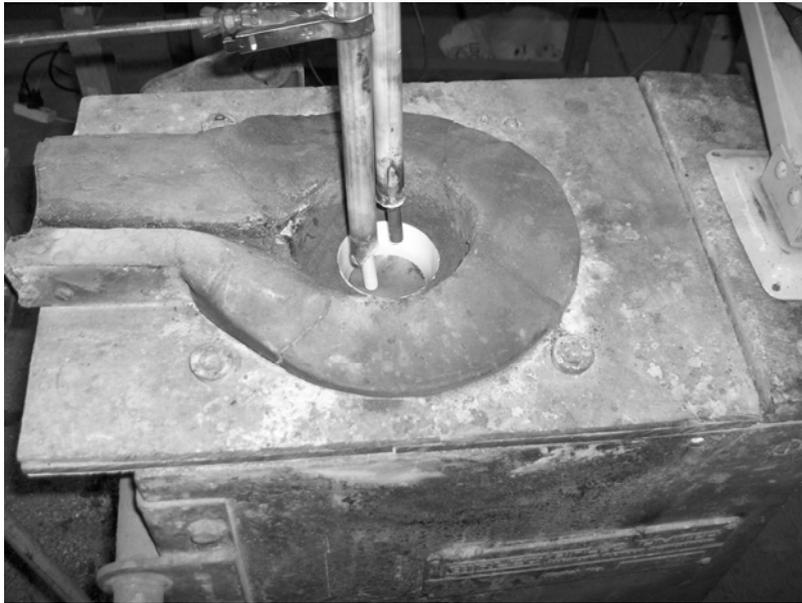
**Figura 13.** Horno de inducción de alta frecuencia conteniendo el crisol con la carga de cobre, el sensor de oxígeno y el termopar.
