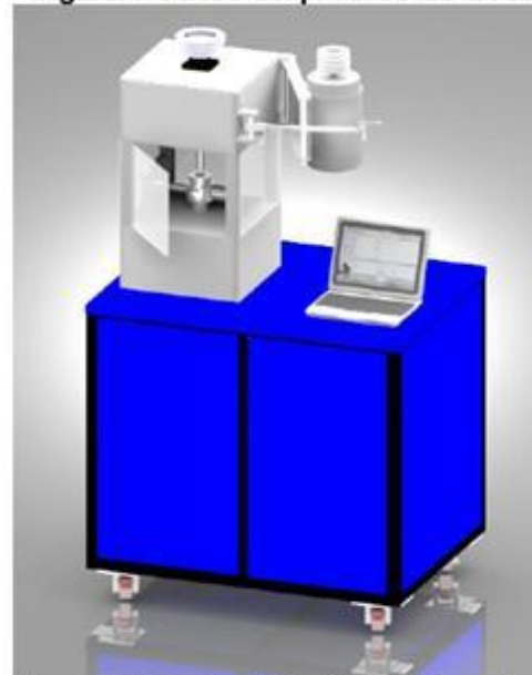
Figura 5 Máquina tribológica de cuatro bolas
