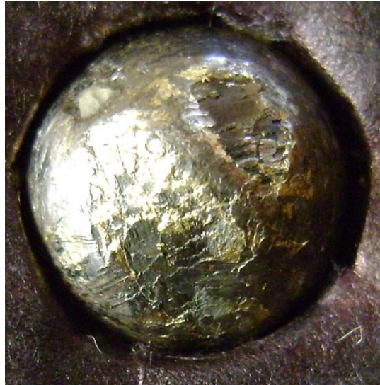
Fig. 139 Marca de desgaste generado por una prueba de extrema presión (ASTM D2783)
