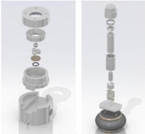
Figura 6 A la izquierda, sistema de sujeción de bolas, a la derecha, sistema de carga.
