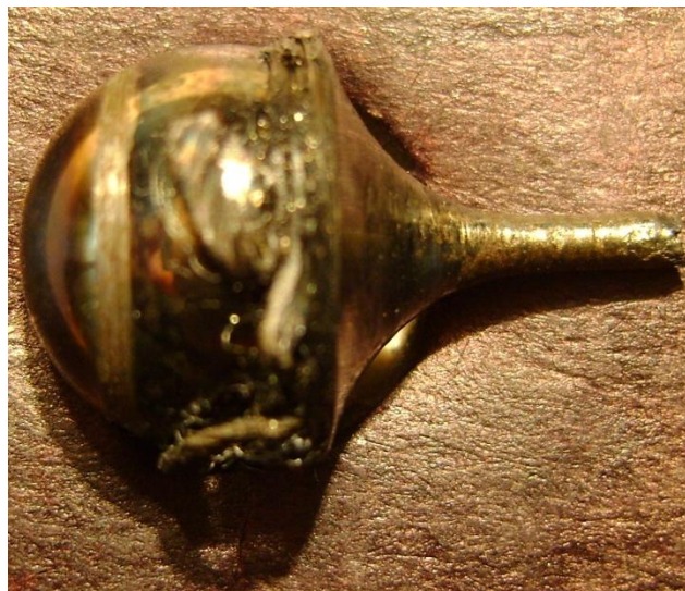
Fig. 140 Marca de desgaste generada por una prueba de extrema presión (ASTM D 2596)
