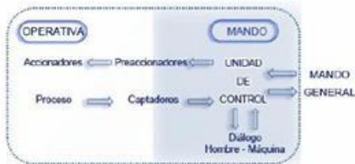
Figura 11 Diagrama operativo de control Para generar el desarrollo del sistema operativo Figura 12, se consideró como objetivo primordial, la interacción visual, entre el operario y el sistema. Para ello, se desarrolló una interfaz gráfica, la cual se basa en un estudio ergonómico, procurando que la misma presente una fácil y accesible operación en su manejo (11). Figura 13.
