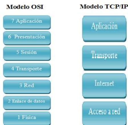
Figura 2.3.-Comparación del Modelo OSI y el Modelo TCP/IP.
