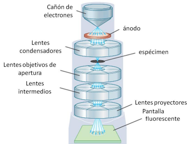
Figura A-10. Esquema básico de un Microscopio de Transmisión de Electrones
