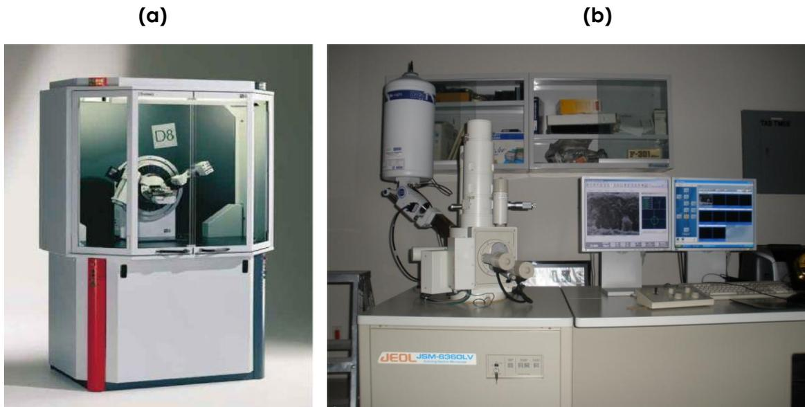
Figura 27. (a) Difractómetro de Rayos X D8 FOCUS, (b) Microscopio Electrónico de Barrido JEOL JSM-6360 LV
