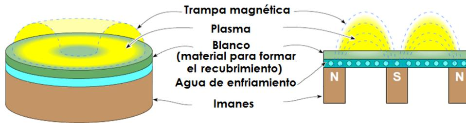
Figura 12. Representación esquemática del principio de sputtering asistido por campo magnético balanceado. [97]
