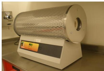
Figura 26. Horno de tubo marca Carbolite.
