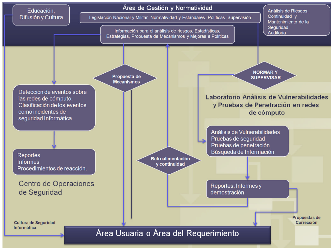
Fig. 3.2-1 Esquema General del Laboratorio de Análisis de Vulnerabilidades y Pruebas de Penetración en redes de cómputo.
