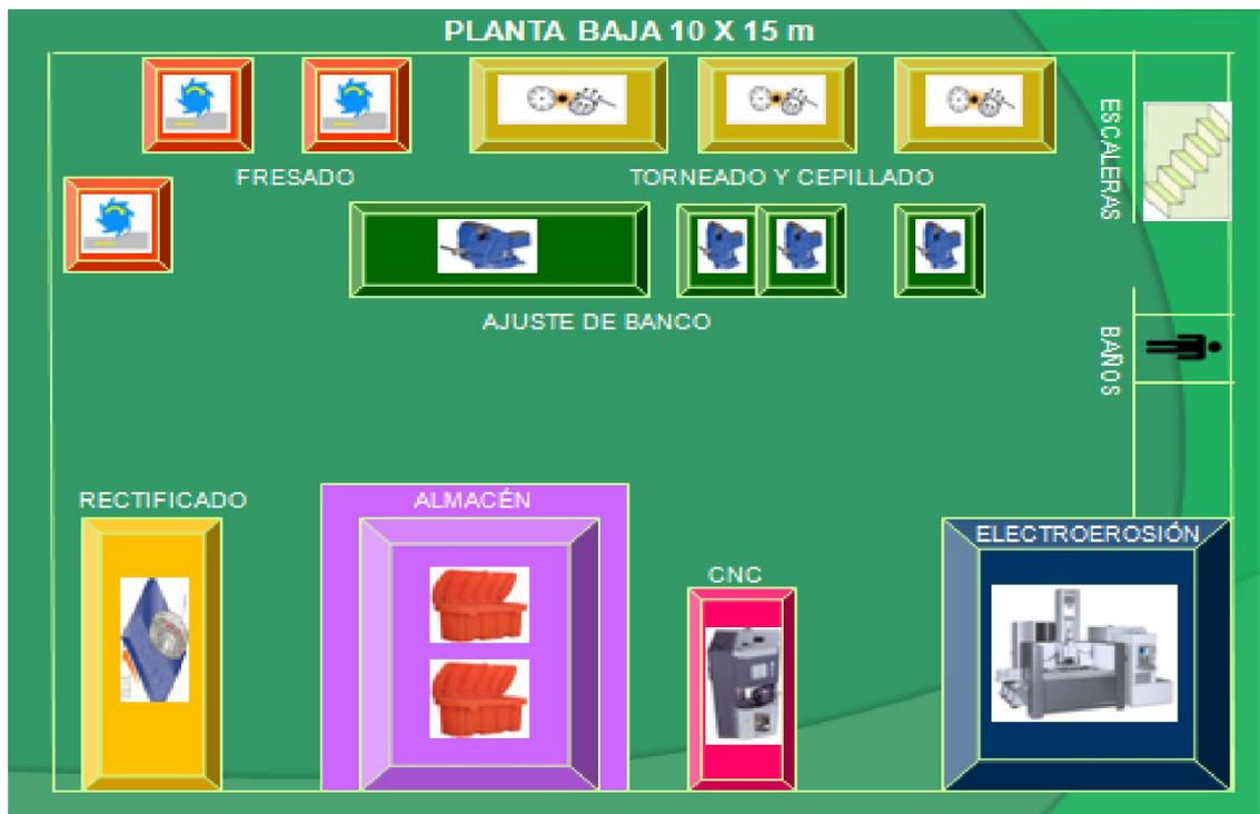
Figura 5. Diagrama de distribución de la planta correspondiente a Planta Baja
