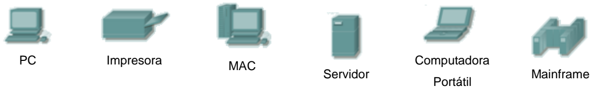
Figura 2.14. No existen símbolos estandarizados para los dispositivos de usuario final en la industria de Networking. Son similares en apariencia a los dispositivos reales para permitir su fácil identificación.
