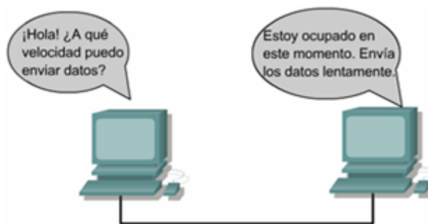
Figura 2.9.A medida que la capa de transporte envía segmentos de datos, trata de garantizar que los datos no se pierdan.
