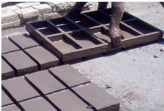
Figura 7. Operación de Moldeo de ladrillo.
