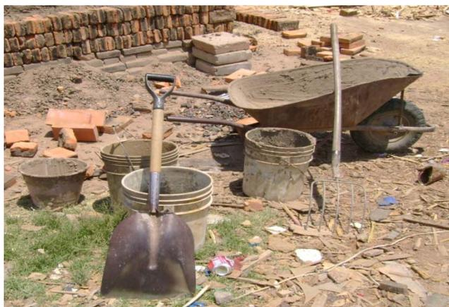
Figura 6. Herramienta manual utilizada en la fabricación de ladrillo.
