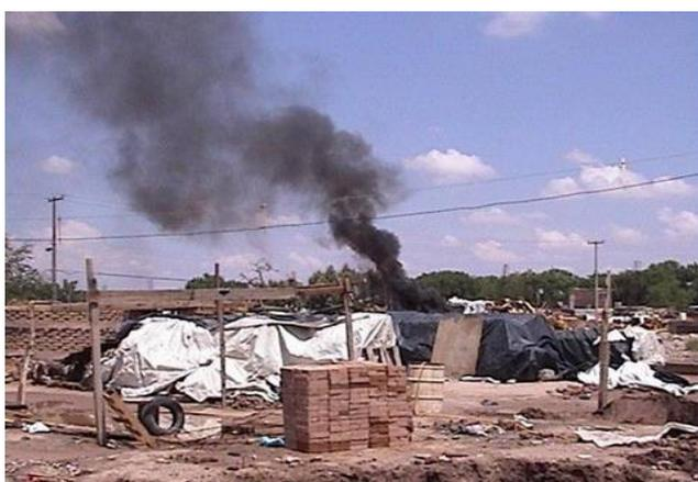
Figura 13. Material combustible prohibido y usado para alimentar el horno, (llantas, plásticos)
