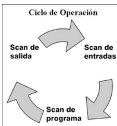
Figura 1.15 Ciclo de operación de un PLC.
