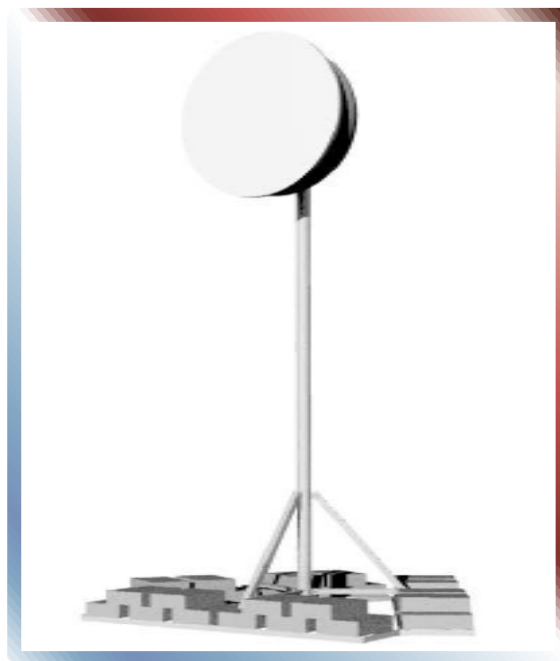
FIG. Nº 83 –Contrapeso de mástiles con tabiques de concreto.
