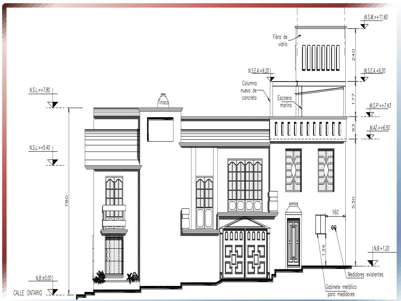
FIG. Nº 14 - Mimetización de torre, obsérvese parte superior, (Cortesía Radiomóvil Dipsa).
