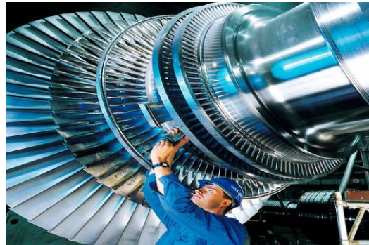
Fig.1.5 Turbina de vapor.
