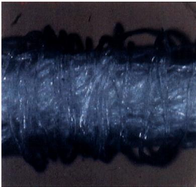
Fotografía de la estructura externa de un hilo universal fabricado a partir de fibras cortas unidas por torsión
