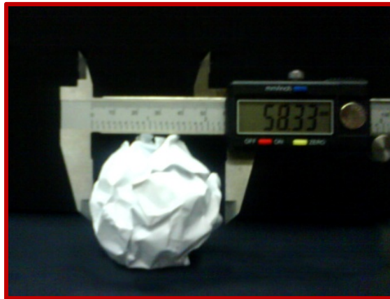
Figura 2.3 Estimación del diámetro de las probetas.
