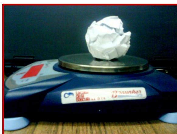
Figura 2.4 Obtención de la masa de cada probeta.
